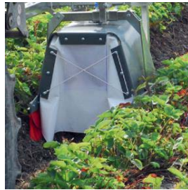
Image : écran de pulvérisation de skovhave.dk pour l'application d'herbicides entre les rangs sur les fraises
